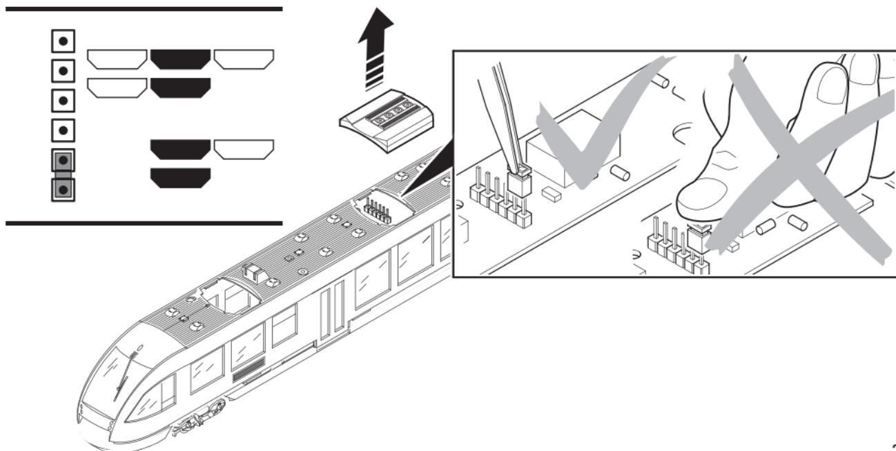
**Steckteile nicht für den Fahrbetrieb**
